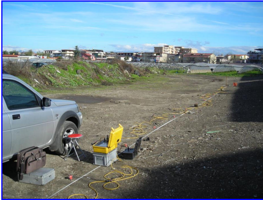
Fig. 1 – Prospezione sismica MASW effettuata in area progettuale.
