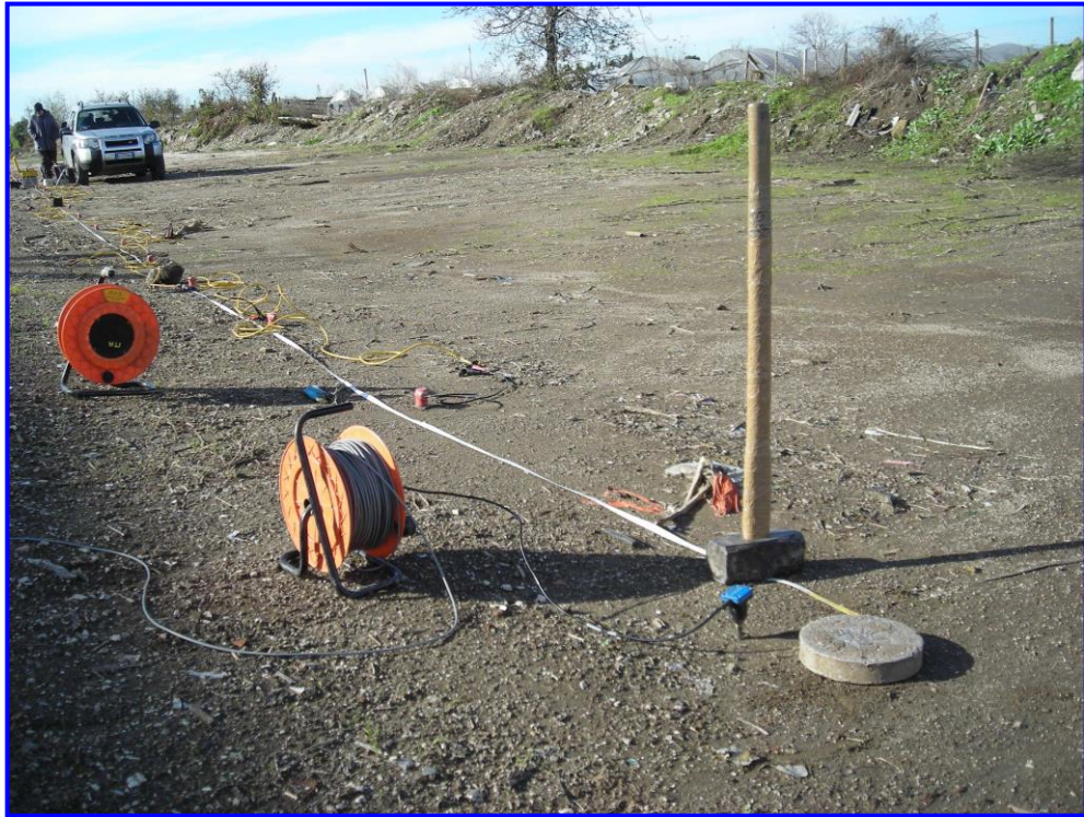
Fig. 13 – Sorgente energizzante, costituita da massa battente su piastra di alluminio. Come starter/trigger è stato utilizzato un geofono verticale Geospace a 14Hz.
