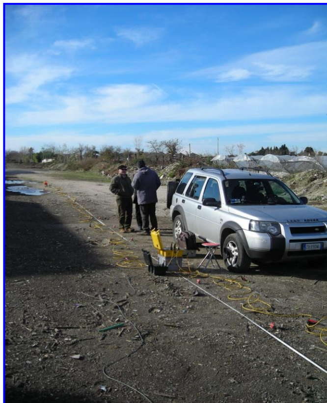
Fig. 1 bis – Prospezione sismica MASW effettuata in area progettuale.
